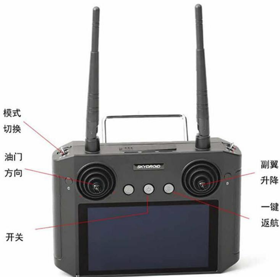
摇杆、开关和旋钮的功能及类型
